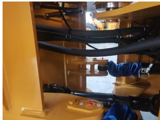
VI. Модернизация и расположение жгута проводов для защиты жгута проводов.
