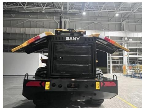
**Капот с боковым открыванием, большое пространство для технического обслуживания**
