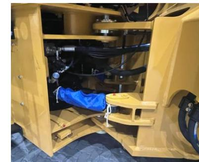
**Навесная конструкция имеет большее расстояние и более удобна в обслуживании**
