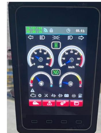
**5,0-дюймовый встроенный TFT-дисплей и экран управления**
